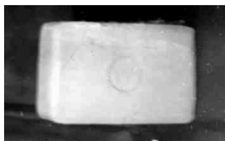
Рис. 4. Фотография контрольного лабораторного образца мыла, иллюстрирующая отсутствие АКНФ на его поверхности, при вводе в его структуру моно системы — бентонита.
