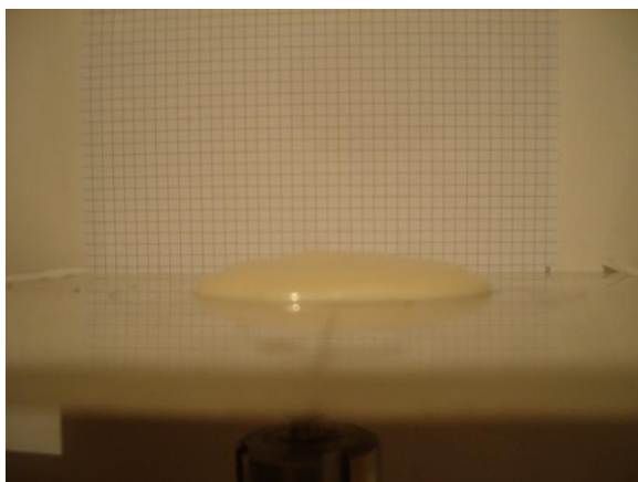
Рис. 4 Размерная сетка для измерений скорости растекания теста
