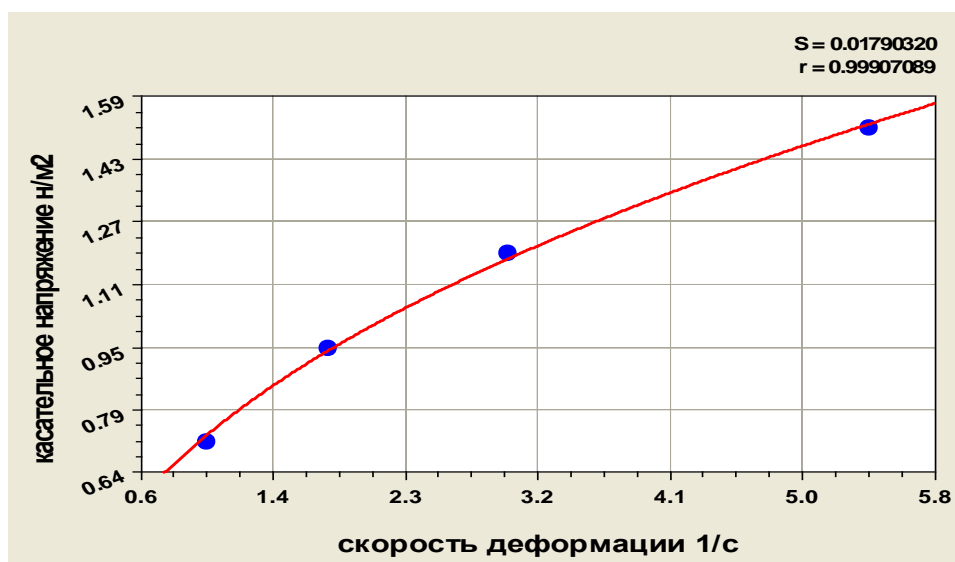
Рис.2 Кривая течения теста при W –55,2%; Sl –0,8 %
