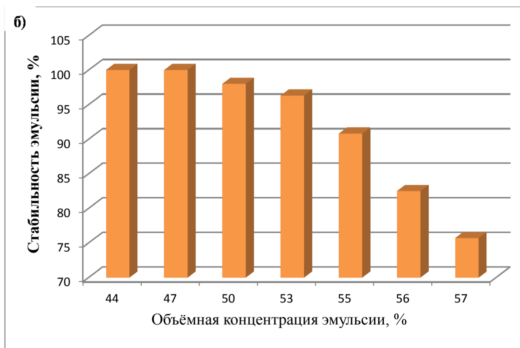
Рисунок 5 (а и б) – Зависимость термомеханической устойчивости эмульсий с использованием препаратов пшеничной клетчатки от их объемных концентраций
