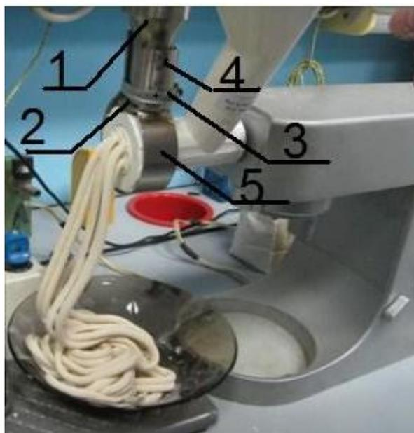
*Рис.1. Конструкция ультразвуковой колебательной системы.*
