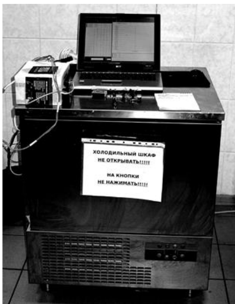
Рис. 1. Экспериментальная установка, включающая шкаф интенсивного охлаждения DM-1, измеритель – Termodat и ноутбук.
