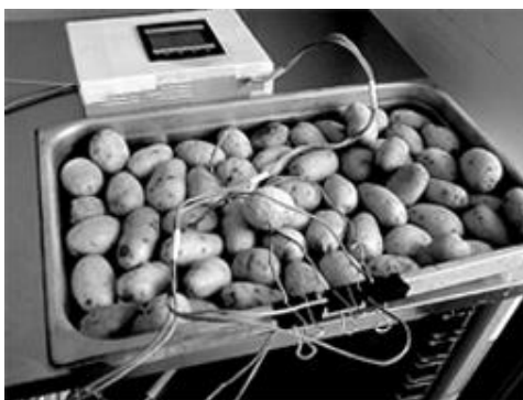
Рис. 2. Замораживаемый картофель с термопарами.
